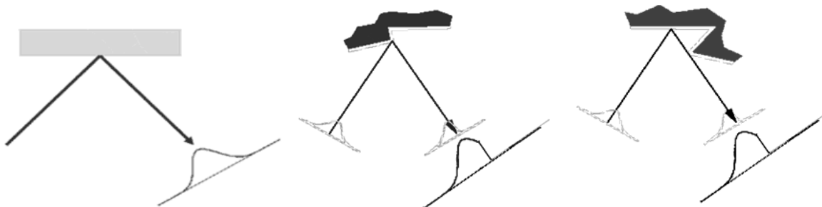
Figuur 21: Ideale reflectie, gedeeltelijke belichting, gedeeltelijke verduistering (uit [18])
