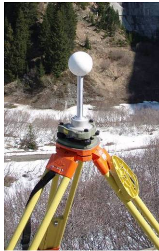
Figura 211: Esfera de Trimble, d=7.6\text{cm} y prisma intercambiable
