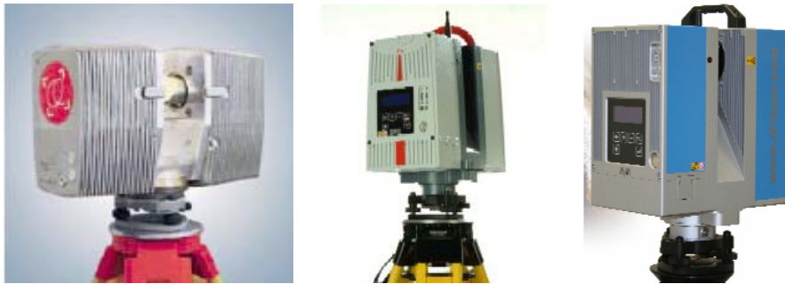
Figura 18: Láseres escáneres comerciales basados en fase
