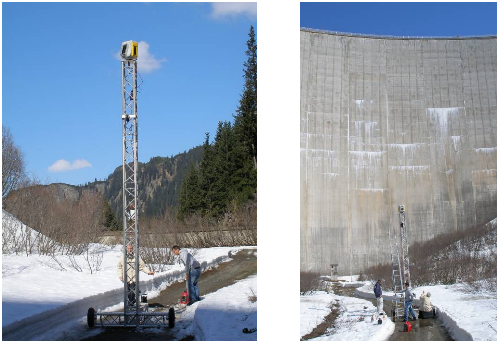
Figura 209: Escáner Móvil, h=6m
