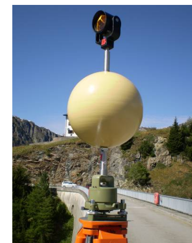
Figura 212: Esfera de madera pintada con un prisma acoplado, d=23.85\text{cm}
